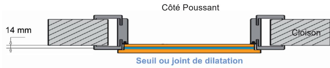
Pour changer de revêtement de sol sous la porte, il faut se placer côté ouvrant dans la pièce. Ensuite tracer au sol l'axe du vantail à recouvrement qui sera de 14mm depuis la cloison pour les portes standard (40mm).
