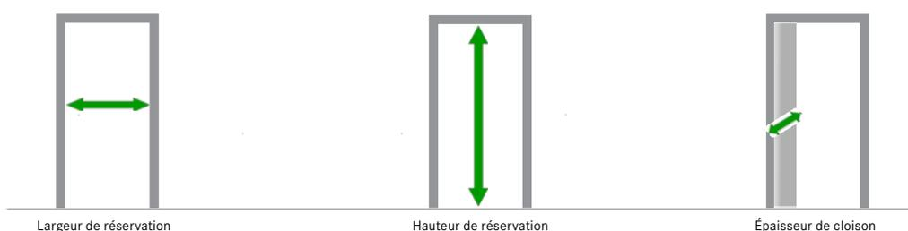
Mesurer en 3 points la largeur, la hauteur et l'épaisseur, prendre en compte la faïence murale et vérifier ci-dessous les dimensions pour s'assurer l'installation des portes standard en fin de chantier.
