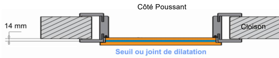
Pour changer de revêtement de sol sous la porte, il faut se placer coté ouvrant dans la pièce. Ensuite tracé au sol l'axe du vantail à recouvrement qui sera de 14mm depuis la cloison pour les portes d'épaisseur standard (40mm).
